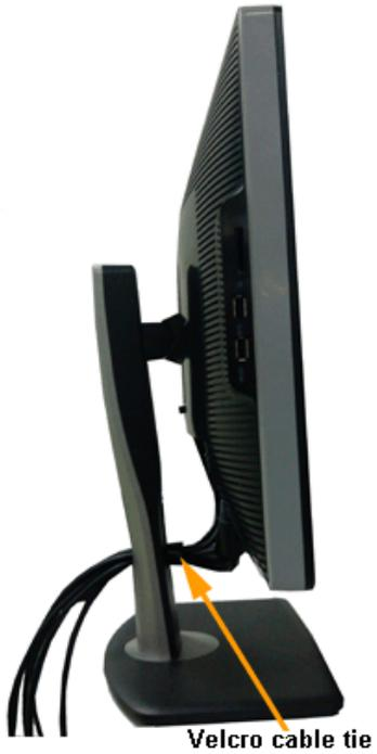
Depois de anexar todos os cabos necessários ao seu monitor e computador, veja [Conectando Seu Monitor](#) para anexar um cabo,) utilize o slot de gerenciamento de cabos para organizar todos os cabos como mostrado acima.
